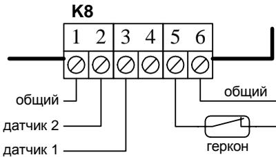
**Пример 2.** Подключение датчиков и герконов (двухдверный и шлюзовой режимы)
