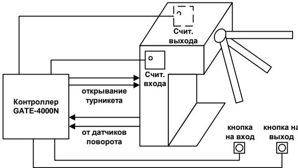
При этом задействовано два реле, два датчика поворота турникета (вместо геркона), два считывателя (вход и выход). В данном варианте подключения обрабатываются все временные события геркона. Используется один банк ключей, максимальная емкость банка – 8144 (16334) ключа.
