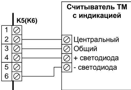
**Пример 4:** подключение считывателя магнитных карт KDR-1321 (1351)
