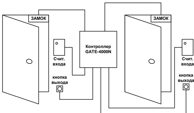
При этом задействовано два реле, два считывателя и две кнопки. Контроллер может быть подключен только со считывателями на вход и с кнопками на выход. Герконы в данном варианте не используются или могут использоваться только для отслеживания события «Взлом двери». Событие «Проход совершен» формируется по факту опознания ключа и срабатывания реле. Используется два независимых банка ключей, максимальная емкость каждого банка – 4072 (8167) ключа.
