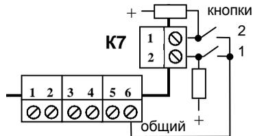
Входы управления кнопками необходимо шунтировать резисторами 1 кОМ на «плюс» питания считывателей для исключения «ложных» срабатываний при длине провода более чем 3 метра.
