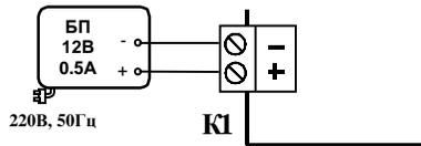
Правильное подключение блока питания соответствует включению на контроллере красного светодиода.
