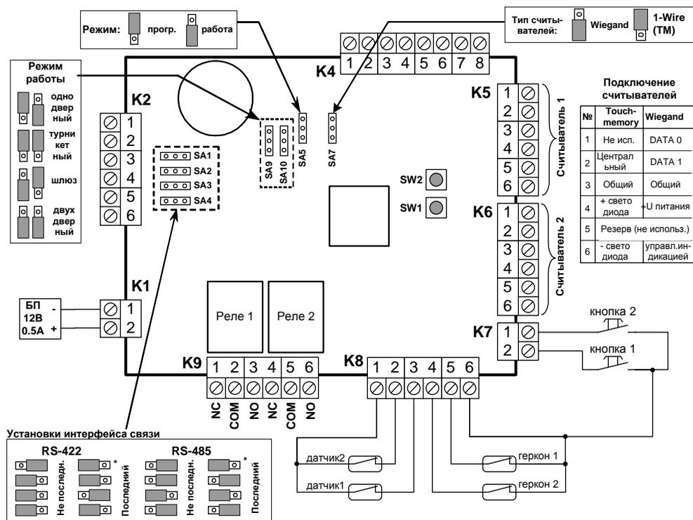
\* данный контроллер последний в сети (подключаются нагрузочные сопротивления встроенные в контроллер).
