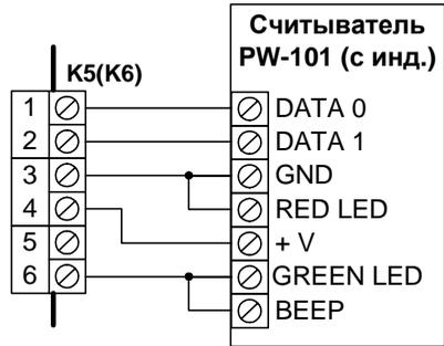
**Пример 3:** подключение считывателя Touch-Memory с индикацией
