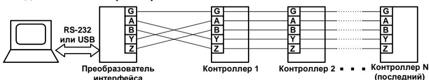
На рисунке приведены два варианта подключения контроллеров к компьютеру. Термин "последний" означает, что контроллер является физически последним в линии связи.
