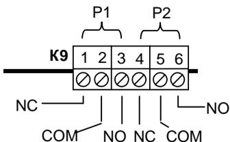
При подключении к контроллеру электромагнитных или электромеханических замков **постоянного тока** их необходимо шунтировать диодами для предотвращения залипания выходных контактов реле P1 и P2 (диоды входят в комплект поставки).
