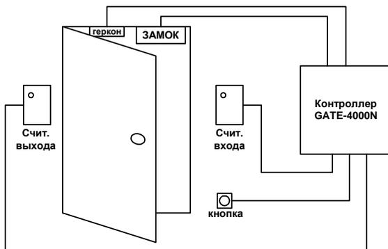
При этом задействовано одно реле, один геркон, два или один считыватель. Контроллер может быть подключен со считывателями на вход и выход или только на вход с выходом по кнопке. В данном варианте подключения обрабатываются все события геркона («Проход совершен», «Проход не был совершен», «Дверь не закрыта», «Дверь закрыта», «Взлом двери»). Используется один банк ключей, максимальная емкость банка – 8144 (16334) ключа.
