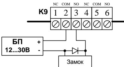
**Пример 3.** Подключение электромагнитного замка (двухдверный и шлюзовой режимы)
