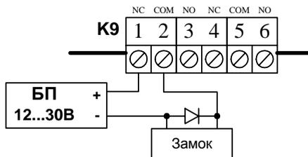
**Пример 2.** Подключение электромеханического замка (одновдверный режим)
